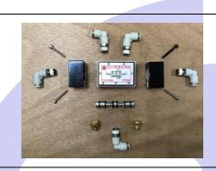
(圖一)零組件拆解爆炸圖 監評人員簽名
